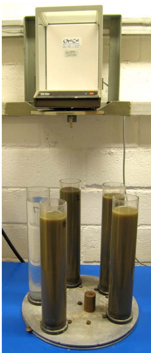
Figur 13. Sedimentationsanalys med vågkropps- metoden.
