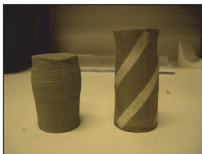
Figur 9 I figuren visas ett prov som har utsatts för aktiv belastning (axiell hoptryckning, det vänstra) och ett prov för passiv belastning (axiell expansion, det högra). Bilden visar lerprov som har torkats ut efter utförd försök. Notera "tunnformen" respektive "timglasformen" som uppstår vid skjuvning till större deformationer
