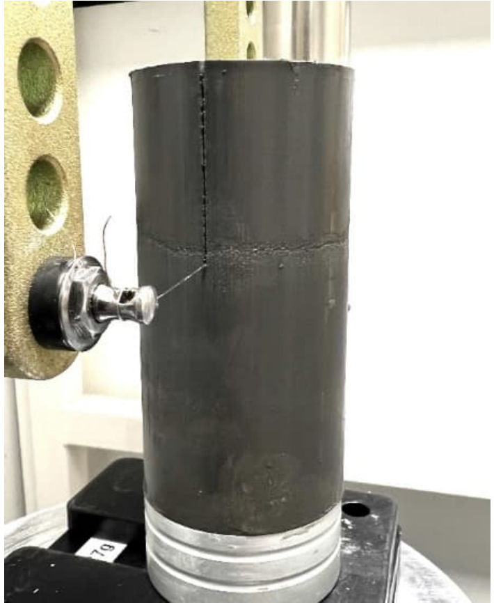
Figur 3 Fotografi av provkropp vid CC-försök.
