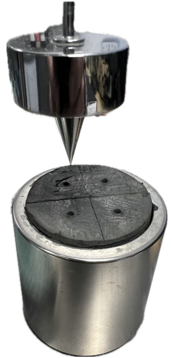
Figur 2 Fotografi av fallkonförsök med 100 g kon.
