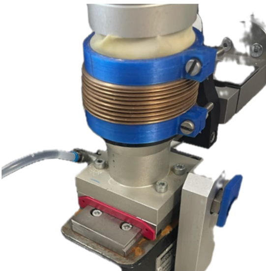
Figur 4 Fotografi av monterat prov i direkt skjuvförsöksutrustning.
